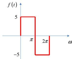
71. Determina los primeros 5 elementos del espectro de amplitud de la forma de onda del problema anterior
