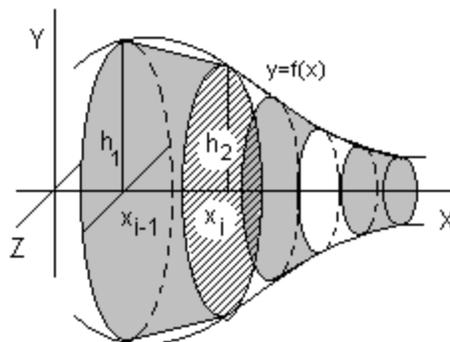
y los puntos correspondientes sobre la curva  $y = f(x)$  pueden unirse con líneas rectas, las cuales al girar en torno al eje  $X$ , generan la superficies laterales de conos truncados .
