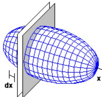
Así por ejemplo en la figura mostrada a la derecha, cada plano perpendicular al eje  $X$  hace un corte en el volumen y tiene cierta área transversal que es función de la posición  $x$ . El volumen diferencial comprendido entre dos planos sucesivos separados entre si por la distancia diferencial  $dx$ , se puede aproximar entonces por el producto :
