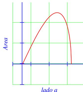
**Ejemplo 16.** De una hoja circular de radio  $R$ , cortar un sector tal que al ser enrollado, se obtenga un embudo cónico de volumen máximo :
