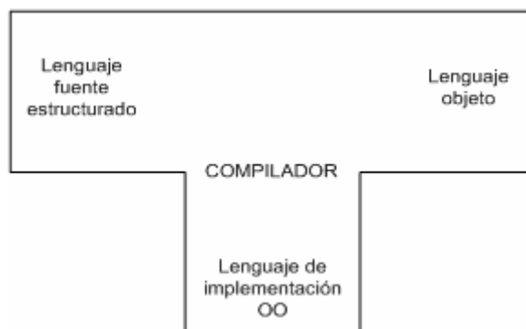
Figura 4-23. Esquema del compilador (T) en que se muestra que el lenguaje fuente y el de implementación son orientados a objetos
