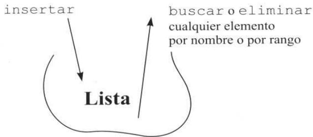
**Figura 6.10** Modelo de lista enlazada: las entradas son arbitrarias, cualquier elemento puede salir y se soporta la iteración, aunque esta estructura de datos no es eficiente en tiempo.
