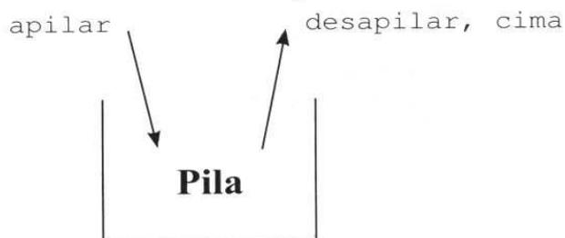
Figura 6.3 Modelo de una pila: la entrada a la pila se realiza con *apilar*, el acceso con *cima* y el borrado con *desapilar*.
