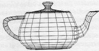
Figura 9.1 La famosa tetera , modelo que consiste en un conjunto de superficies curvas suaves.
