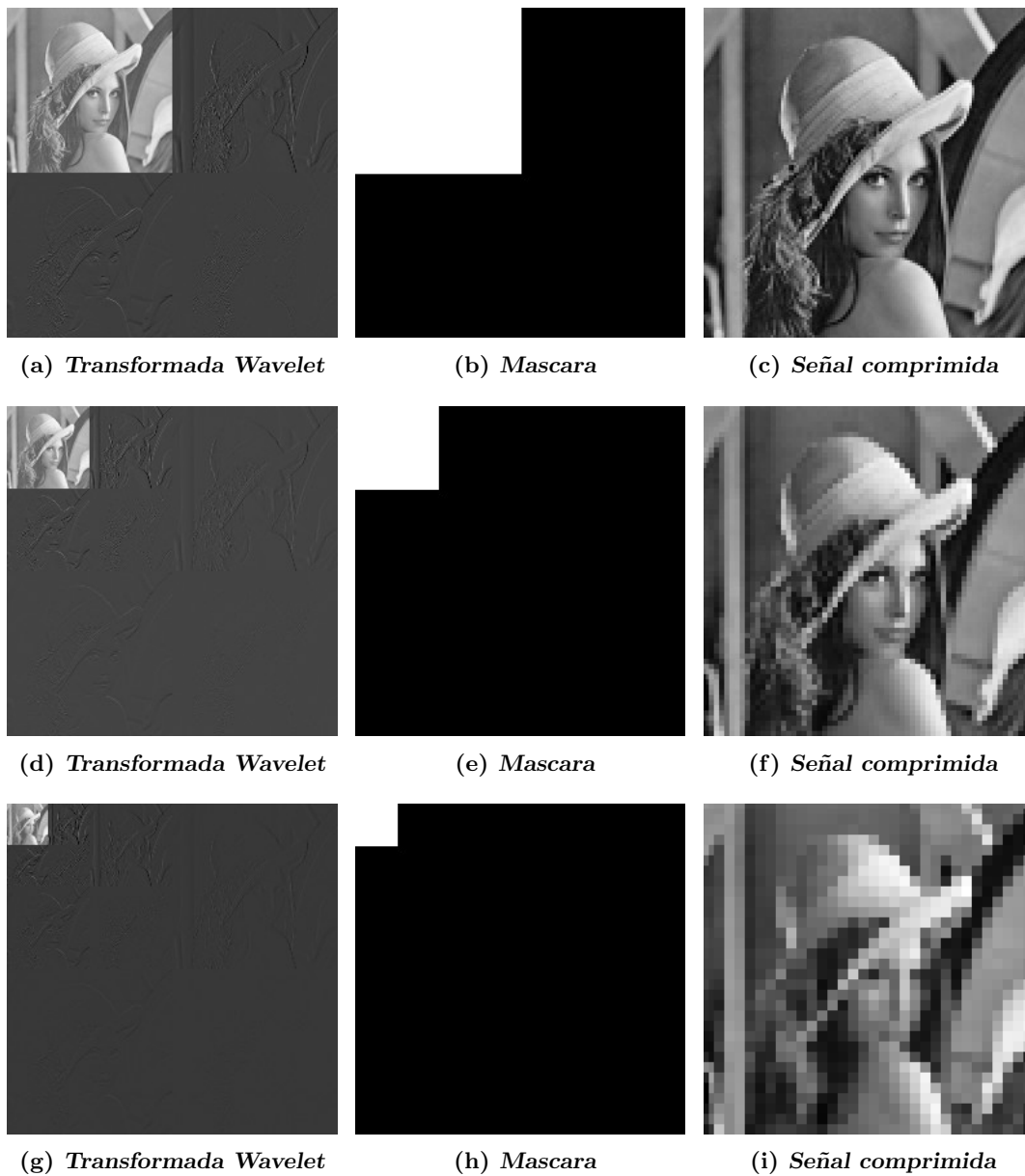
Figura 7.20: Ejemplo de filtrado y compactación de una imagen utilizando Transformada Wavelet
