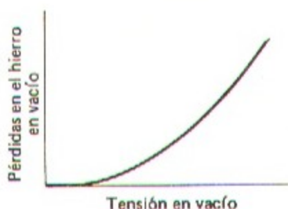
Fig. 6-10. Curva de pérdidas en el hierro en vacío.
