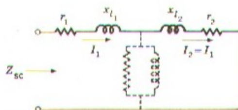
Fig. 1-28. Circuito equivalente con el secundario en cortocircuito.
