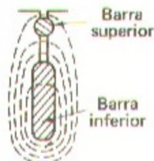
Fig. 7-17. Barras de un rotor de doble jaula y flujo disperso en la ranura.
