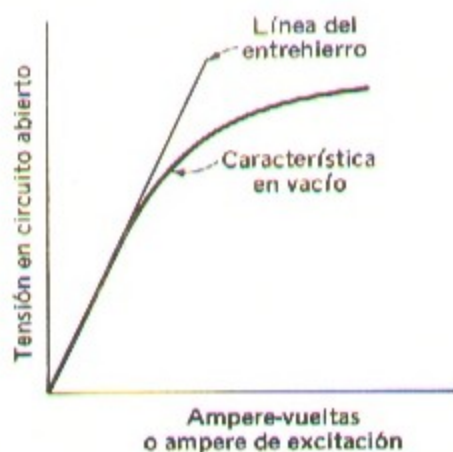
Fig. 4-15. Característica en circuito abierto y línea del entrehierro.
