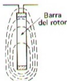
Fig. 7-15. Barra alta en un rotor y flujo de dispersión en la ranura.
