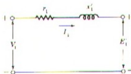
Fig. 10-11. Circuito equivalente transitorio simplificado de una máquina de inducción.
