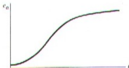
Fig. 9-19. Subida de tensión en un generador derivación.
