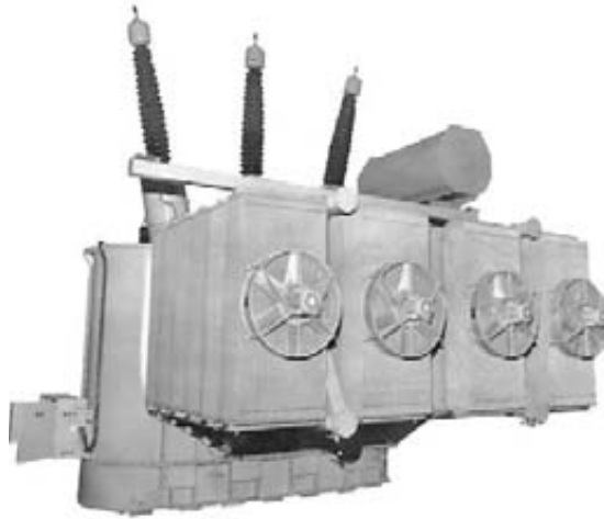
Figura 12.10c El mismo transformador listo para ser enviado. Fue sometido a una prueba de impulsos de 1050 kV en el lado de alto voltaje y a una prueba similar de 250 kV en el lado de bajo voltaje. Otros detalles: capacidad de potencia: 110 MVA/146.7 MVA (OA/FA); masa total incluido el aceite: 158.7 t; altura total: 9 m; ancho: 8.2 m, longitud: 9.2 m. (Cortesía de ABB)
