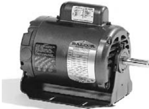
Figura 18.15 Motor monofásico de arranque con capacitor montado en una base elástica para reducir la vibración y el ruido transmitidos a la superficie de montaje. El motor de 1/3 hp, 1725 r/min, 230 V y 60 Hz tiene una corriente a plena carga de 3.0, una eficiencia de 60 por ciento y un factor de potencia de 60 por ciento. Otras características: corriente sin carga: 2.6 A; corriente con el rotor bloqueado: 13 A; momento de torsión con el rotor bloqueado: 3.6 pu; momento de torsión máximo: 3 pu; factor de servicio: 1.35; peso total: 10 kg; longitud total incluido el eje: 278 mm; altura total: 232 mm. (Cortesía de Baldor Electric Company)
