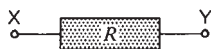
Figura 2.11 La corriente puede fluir de X a Y o de Y a X.
