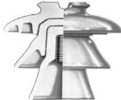
Figura 25.2 Vista en corte de un aislador tipo pasador de 69 kV. BIL: 270 kV; voltaje de salto a 60 Hz en condiciones húmedas: 125 kV. (Cortesía de Canadian Ohio Brass Co. Ltd.)
