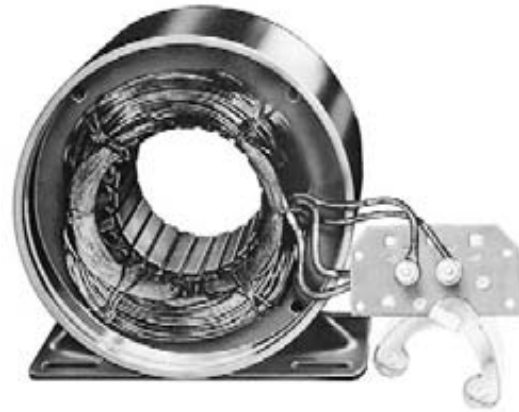
Figura 18.4 Devanados principal y auxiliar de un motor monofásico de 2 polos. El contacto estacionario en serie con el devanado auxiliar se abre cuando el interruptor centrífugo, montado en el eje, alcanza 75 por ciento de la velocidad síncrona.
