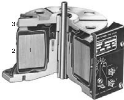
Figura 11.21 Corte de un autotransformador variable de 0-140 V y 15 A operado manualmente, que muestra (1) el núcleo toroidal laminado; (2) el devanado de una capa; (3) la escobilla móvil. (Cortesía de American Superior Electric)
