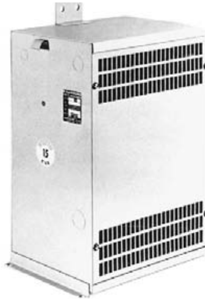
Figura 10.15 Transformador monofásico tipo seco AA, con capacidad de 15 kVA, 600 V/240 V y 60 Hz, aislante clase 150° para uso bajo techo. Altura: 600 mm; ancho: 434 mm; profundidad: 230 mm; peso: 79.5 kg. (Cortesía de Hammond)
