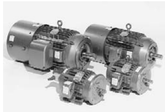
Figura 14.2 En primer plano se muestran dos motores de jaula sin ventilación totalmente cerrados (TENV, por sus siglas en inglés) de 2 hp y 1725 r/min, y en segundo plano dos motores enfriados por ventilador totalmente cerrados (TEFC, por sus siglas en inglés) de 30 hp y 1780 r/min. Estos motores trifásicos de 460 V están hechos para operar a velocidades variables que van de unas cuantas revoluciones por minuto a cerca de 3 veces la velocidad nominal.
