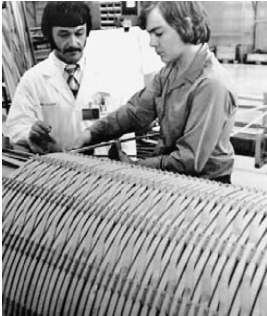
Figura 10.9c Devanado primario de un transformador más grande, de 128 kV y 290 A. (Cortesía de ABB)
