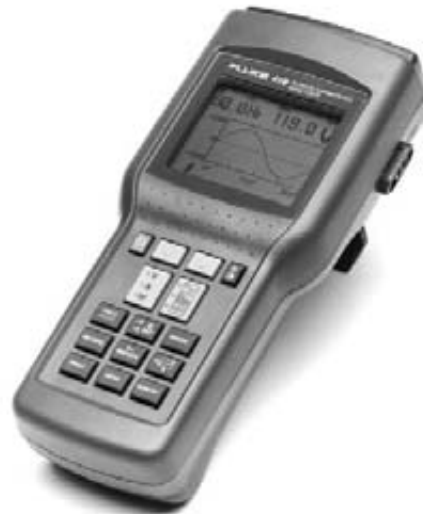
Figure 30.45 Este instrumento portátil, el “Power Harmonics Analyzer”, puede medir la distorsión armónica total (THD) de un voltaje o corriente hasta el 31er. armónico. También puede medir la potencia activa, reactiva y aparente de un circuito trifásico, así como su factor de potencia. También lee el factor K de una corriente. (Cortesía de Fluke Electronics Canada Inc.)
