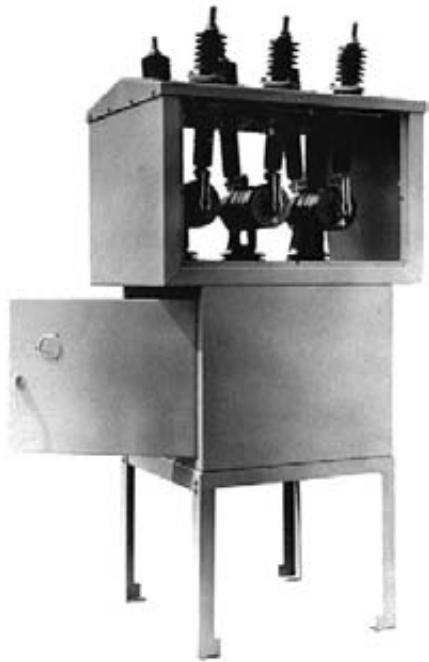
Figura 26.8 Cortacircuito trifásico de vacío con capacidad de 1200 A a 25.8 kV. Puede interrumpir una corriente de 25 kA en 3 ciclos en un sistema de 60 Hz. Otras características: altura: 2515 mm; masa: 645 kg; BIL: 125 kV. (Cortesía de General Electric)
