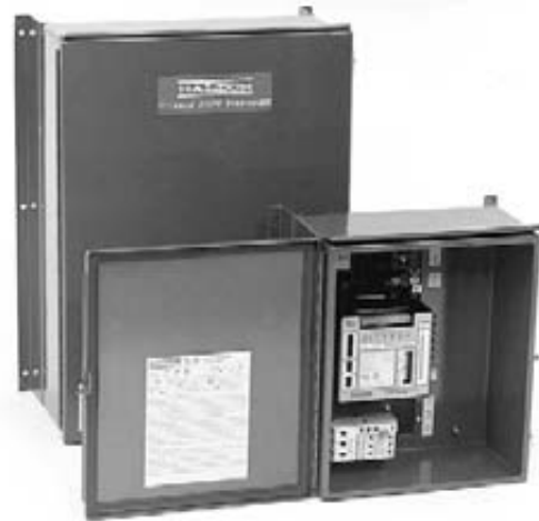
Figura 23.23b Arrancador suave transistorizado de 5 hp, 460 V y 60 Hz. Tiempo de arranque ajustable de 5-50 s; ajuste de par o momento de torsión inicial de 0-75%; programa de limitación de corriente de 75%-400%; tiempo de arranque de transición ajustable de 0-1.5 s. En el fondo se muestra un arrancador suave de 40 hp y 460 V. (Cortesía de Baldor Electric Company)
