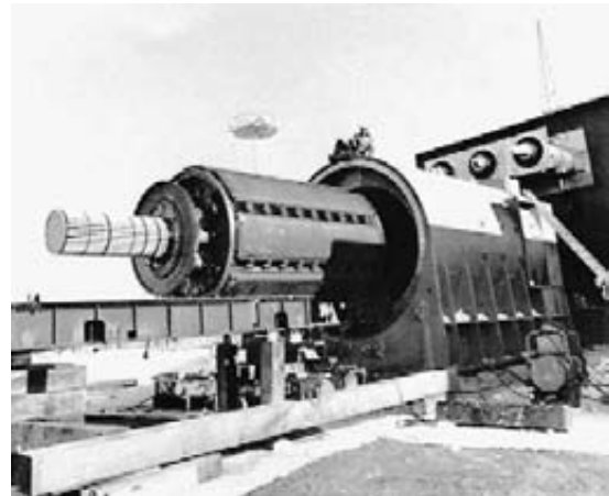
Figura 17.24a Capacitor síncrono trifásico de 16 kV y 900 r/min, con una capacidad de -200 Mvar (suministra potencia reactiva) a +300 Mvar (absorbe potencia reactiva). Se utiliza para regular el voltaje de una línea de transmisión de 735 kV. Otras características: masa del rotor: 143 t; diámetro del rotor: 2670 mm; longitud axial del hierro del estator: 3200 mm; longitud del entrehierro: 39.7 mm.
