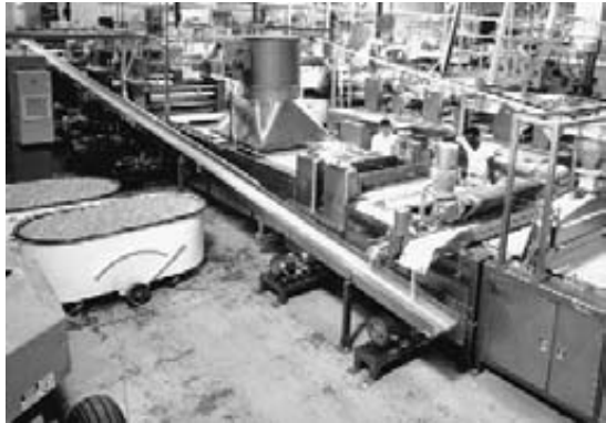
Figura 23.35 El procesamiento de alimentos es una de las incontables aplicaciones industriales donde se utilizan controles PWM. Un buen ejemplo es la línea de producción de Worts® Company, en Poteau, Oklahoma, ilustrada aquí. Esta línea de horneado y empaçado, que produce 1000 cajas de galletas saladas cada 10 minutos, está equipada con 44 controles PWM más otros 35 motores individuales. Los controles permiten el control preciso de todo el proceso de producción. El tiempo muerto y el mantenimiento del sistema de control son mucho menores en comparación con las viejas líneas de horneado que utilizan controles mecánicos. (Cortesía de Baldor Electric Company)
