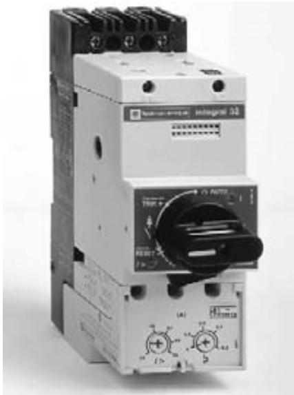
Figura 20.21 Arrancador especial autoprotegido de 40 hp, 460 V y 60 Hz. Además de capacidad para cortocircuito de 42 kA a 460 V, tiene ajustes de activación térmicos y magnéticos. Dimensiones totales: 243 mm de alto; 90 mm de ancho, 179 mm de fondo. (Cortesía de Telemecanique, Groupe Schneider)
