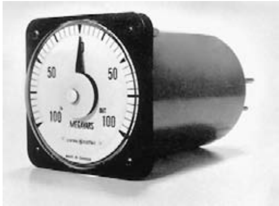
Figura 7.5 Varímetro con el valor cero en el centro de la escala. Indica flujo de potencia reactiva positiva o negativa hasta de 100 Mvars.
