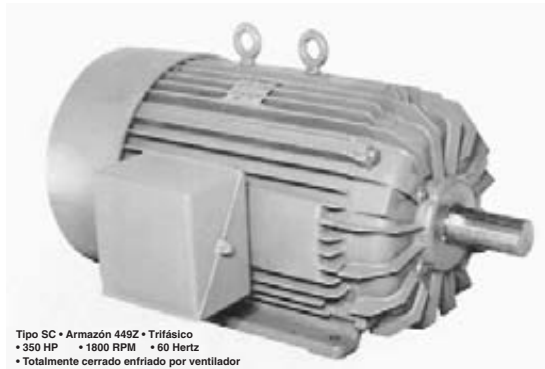
Figura 14.3 Motor de inducción trifásico totalmente cerrado y enfriado por ventilador, de 350 hp, 1760 r/min, 440 V y 60 Hz. (Cortesía de Gould)
