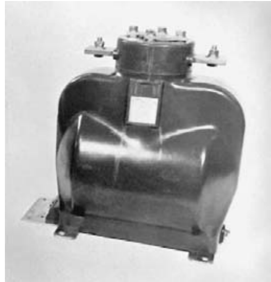
Figura 11.17 Transformador de corriente de 50 VA, 400 A/5 A, 60 Hz, encapsulado en material epóxico (epoxy) y aislado para 36 kV. (Cortesía de Montel, Sprecher & Schuh)
