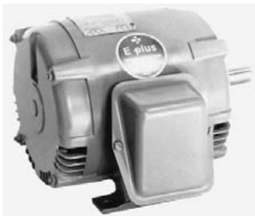
Figura 14.1 Motor de inducción trifásico de jaula de ardilla, a prueba de goteos y energéticamente eficiente, de 230 V/460 V, 3 hp, 1750 r/min, 60 Hz. (Cortesía de Gould)
