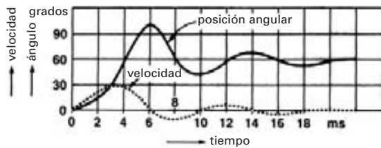
Figura 19.3 Las mismas condiciones que en la figura 19.2, excepto que la inercia es mayor. El rebase es mayor y el rotor requiere más tiempo para detenerse.
