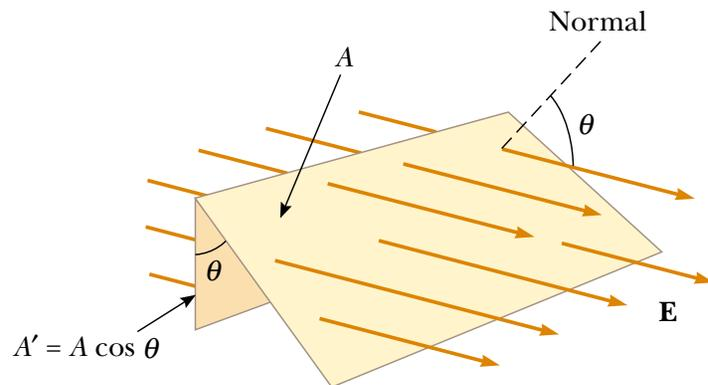
Considere un campo eléctrico uniforme, tanto en magnitud como en dirección como se muestra en la Fig. 3.2. Las líneas de campo penetran la superficie rectangular de área  $A'$ . El número de líneas por unidad de área (densidad de líneas de campo) es proporcional a la magnitud del campo eléctrico. Por lo tanto el número de líneas que penetran la superficie perpendicular es proporcional al producto  $EA'$ . Este producto es la magnitud del campo eléctrico  $E$  en una superficie de área  $A'$ .
