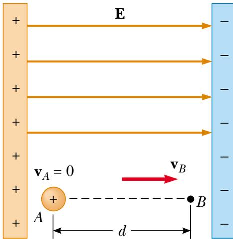
Un Protón es colocado dentro de un campo eléctrico uniforme con una magnitud de  $8.0 \times 10^4 \text{ V/m}$ . Considere que el protón se mueve una distancia  $d = 0.50 \text{ m}$  como se ilustra en la Figura 4.3. Encuentre el cambio del potencial eléctrico entre el punto A (inicio del movimiento) y el punto B (final del movimiento)
