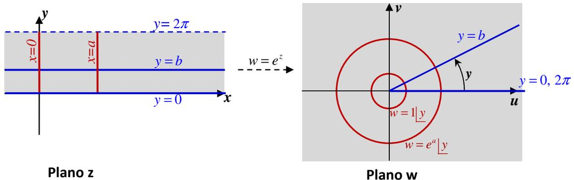
Figura 1.20.- Mapeo de rectas horizontales y verticales mediante la función  $w = e^z$ .
