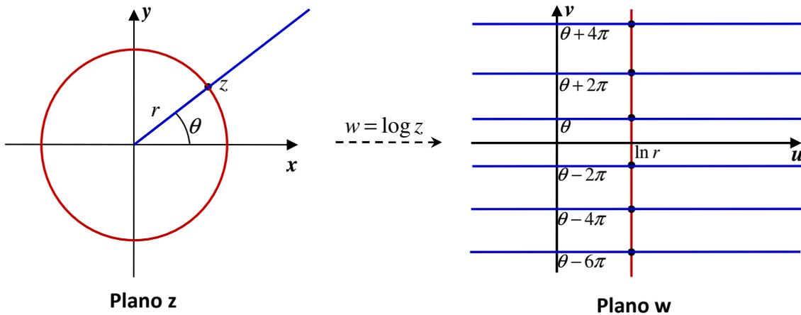
Figura 1.21.- Mapeo de un círculo de radio  $r$  y una semirecta inclinada mediante la función  $w = \log(z)$ .
