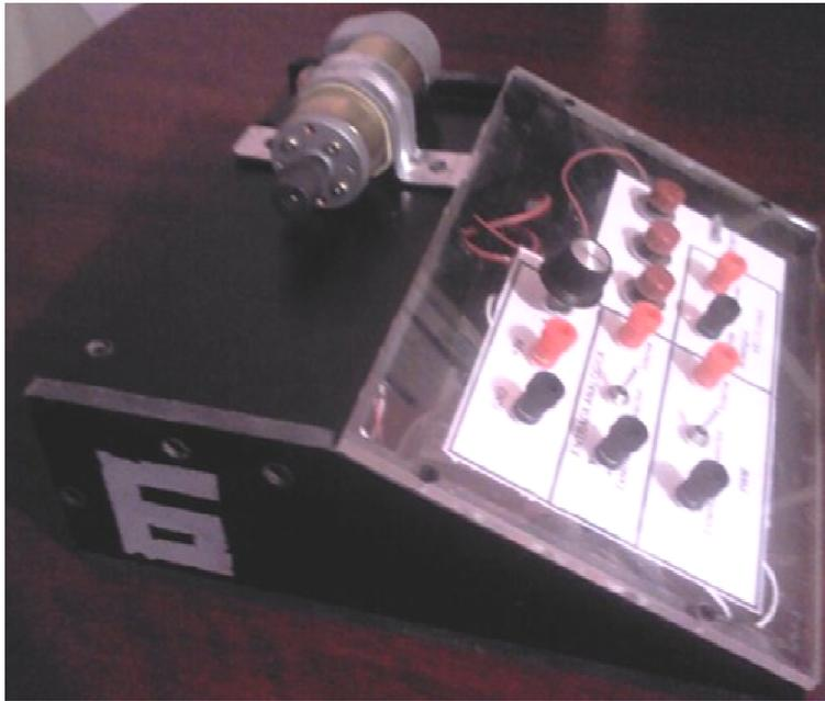
Figura 1.- Aspecto externo del módulo experimental de control de velocidad de un motor de CD.
