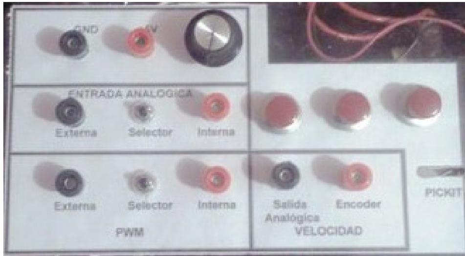
Figura 3.- Panel frontal del sistema de control de velocidad
