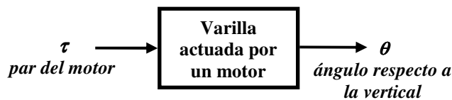
Figura 5.3.- Modelo entrada-salida de la varilla actuada por el motor.
