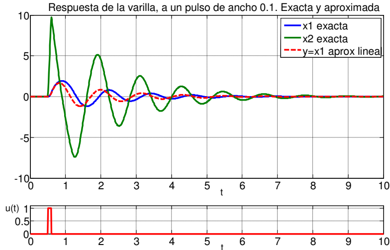
Figura 5.7.- Respuesta de la varilla a un pulso de ancho 0.1 y amplitud 1, calculada mediante el modelo no lineal exacto (4.7) y el modelo lineal aproximado (4.20).
