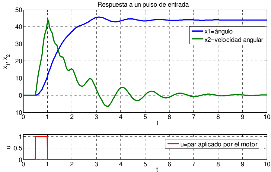
Figura 5.6.- Respuesta de la varilla a un pulso de par aplicado por el motor.
