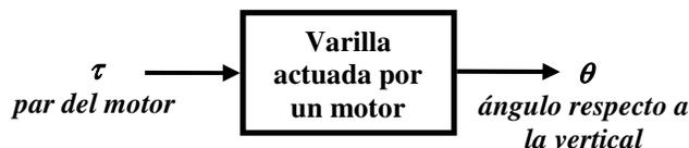
Figura 6.3.- Modelo entrada-salida de la varilla actuada por el motor.
