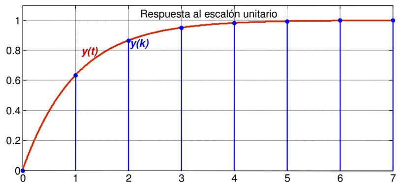
Fig. 3.4. Respuesta al escalón unitario del sistema de primer orden continuo y su equivalente discreto.
