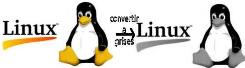
Figura 1: Al aplicar la función **RGBtoGrises** a una imagen, se obtiene el valor promedio de los valores RGB y se almacena el valor resultante en la matriz de datos, el valor resultante se observa del lado derecho de la figura.
